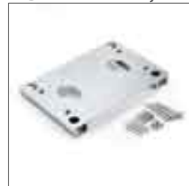
Podwyższona płyta fundamo- ntowa. Zamocowana do podłoża 4 prętami \varnothing 11 w rozstawieniu osi- owym 280 x 170, z zamocowaniem silnika 4 śrubami M10 w rozstawi- eniu osiowym 269 x 106
