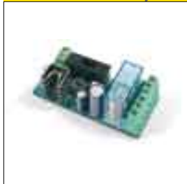
Karta ładowania akumulatora dla typu LADY
